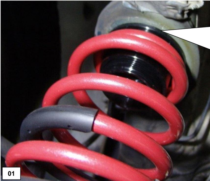
Die Höhenverstellung wird oben montiert u. ersetzt die serienmäßige Federunterlage. Eingestellt ist das minimale Maß! Der max. Verstellbereich beträgt **20mm** (siehe Bild 3).
