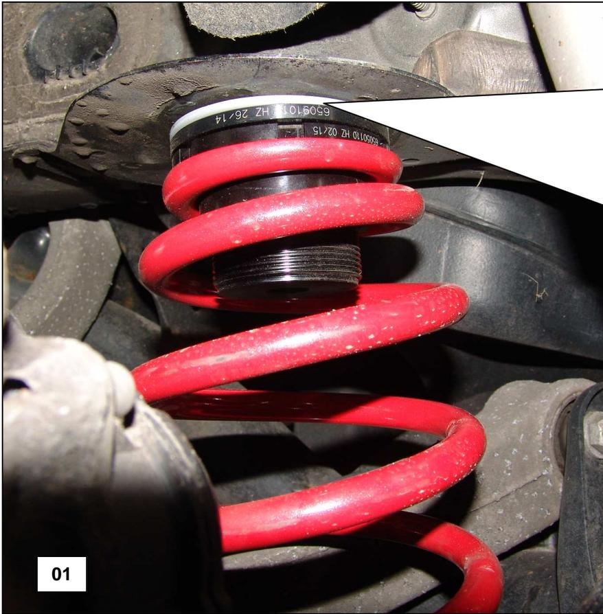
Die Höhenverstellung wird oben montiert u. ersetzt die serienmäßige Federunterlage. Zwischen der Karosserie und der Höhenverstellung wird die mitgelieferte Kunststoffscheibe montiert.
